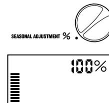
Pour visualiser les nouveaux temps d'arrosage, tourner le bouton sur <RÉGLAGE TEMPS D'ARROSAGE> (Run Times). Les nouveaux temps d'arrosage correspondants au réglage saisonnier s'affichent.
